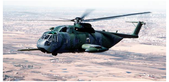
Sikorsky S-61R – (Notez la perche de ravitaillement qui s'allonge sous le rotor)
