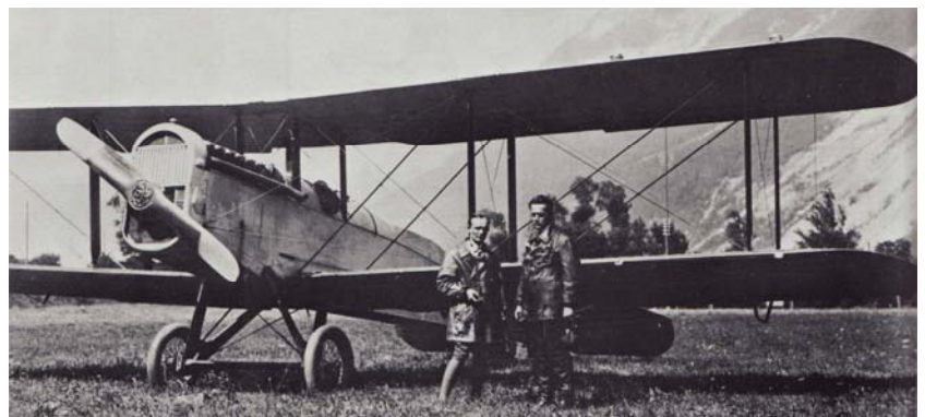
Bombardier De Havilland (DH-4) avec tir à travers l'hélice. (Observer le blindage) ↑
