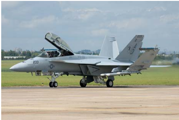
Boeing F18 Super Hornet... Avec ses nouvelles entrées d'air rectangulaires qui le différencie de l'ancien F 18 Hornet
